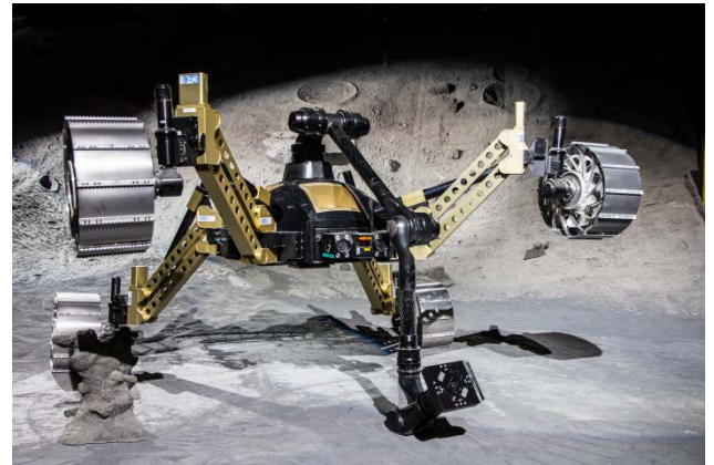
Sherpas Manipulator ist stark genug, um den Roboter zu stützen, wenn zwei Räder vom Boden gehoben werden.
