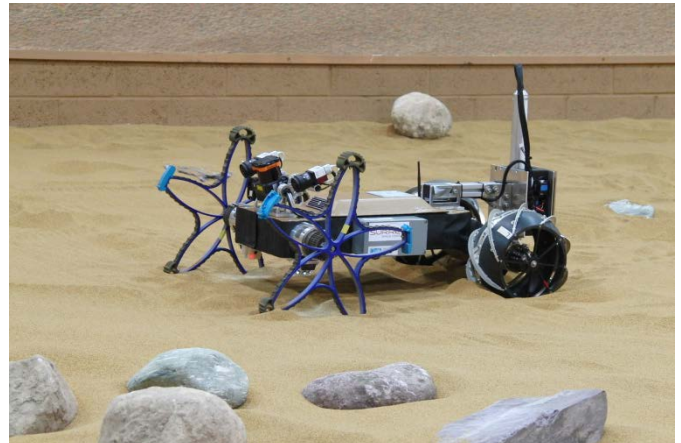
Coyote II mit voller Sensorausrüstung inklusive der vom Surrey Space Center entwickelten Soil Sensor System Nutzlast
