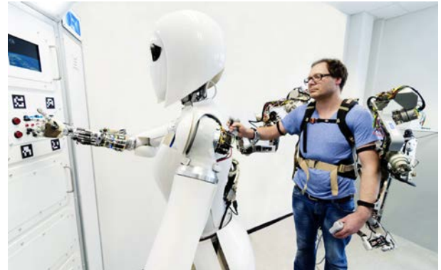
Teleoperationsszenario: Fernsteuerung des Robotersystems AILA
