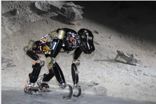
Der hominide Explorationsroboter Charlie beim vierbeinigen Laufen
