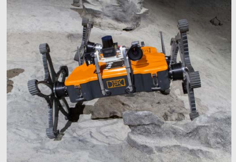
Der als Shuttle fungierende Coyote III überwindet unebenes Gelände
