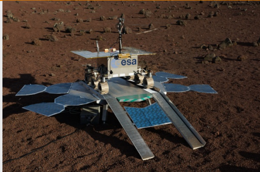
Testrover ExoMars (ExoTeR) ist eine 1:2 skalierte Version des ExoMars Rovers. ExoTeR ist auch die Testplattform des SARGON Projekts. (Foto: Martin Azkarate, ESA, HESpace)
