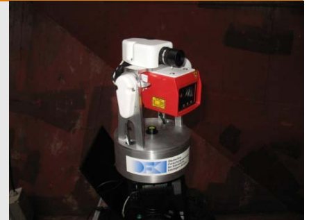
Ein optischer Laser-Tracker ermöglicht die Lokalisierung der Minoas-Systeme in 3D.
