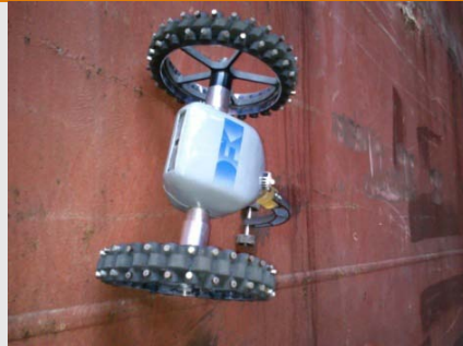
DFKI-Prototyp für einen ultraleichten Magnet Crawler für die Inspektion von Schiffshüllen.
