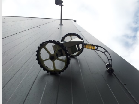
Ein ultraleichter magnetischer Crawler für die Inspektion von Frachträumen und Rümpfen.
