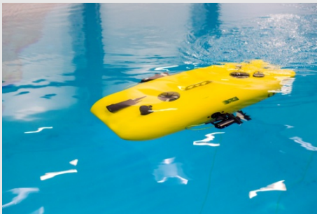
AUV DAGON bei einer Testfahrt im großen Salzwasserbecken des DFKI Robotics Innovation Center
