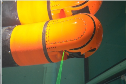
Abb. 2: Inspektionseinheit (HD-Kamera, Structured Light System, Multibeam Profiling Sonar)
