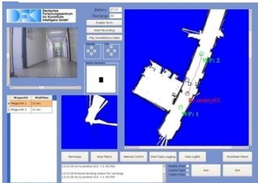
Die Navigation erfolgt über einen Laserscanner; Radare und PIR dienen der Bewegungsdetektion.
