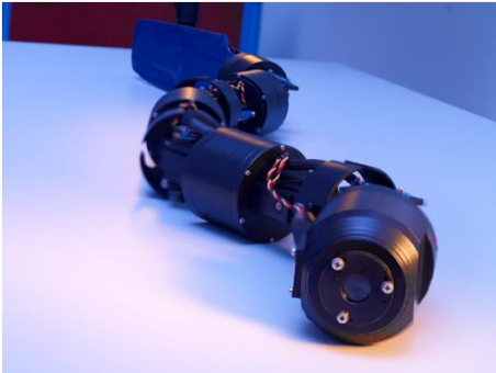
Struktur des schlangenähnlichen Roboters MEHEN
