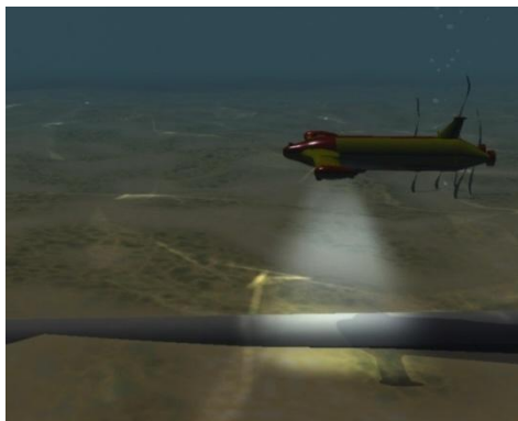
Sicht eines auf Pipeline-Tracking spezialisierten AUV, im multimodalen Suchmodus
