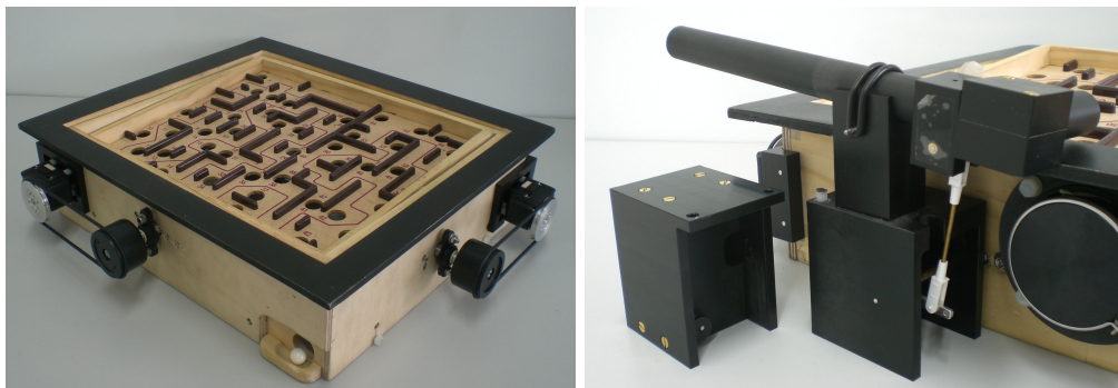
(a) Servomotoren zur Steuerung der Brettneigung
