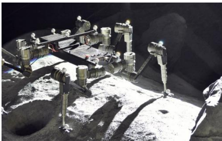
Die voll funktionsfähige SpaceClimber Integrationsstudie im DFKI RIC Space Testbed
