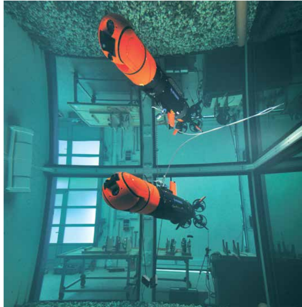
Tauchgang im verglasten Wasserbecken: ein AUV der Firma ATLAS Elektronik mit integrierter DFKI-Technologie
