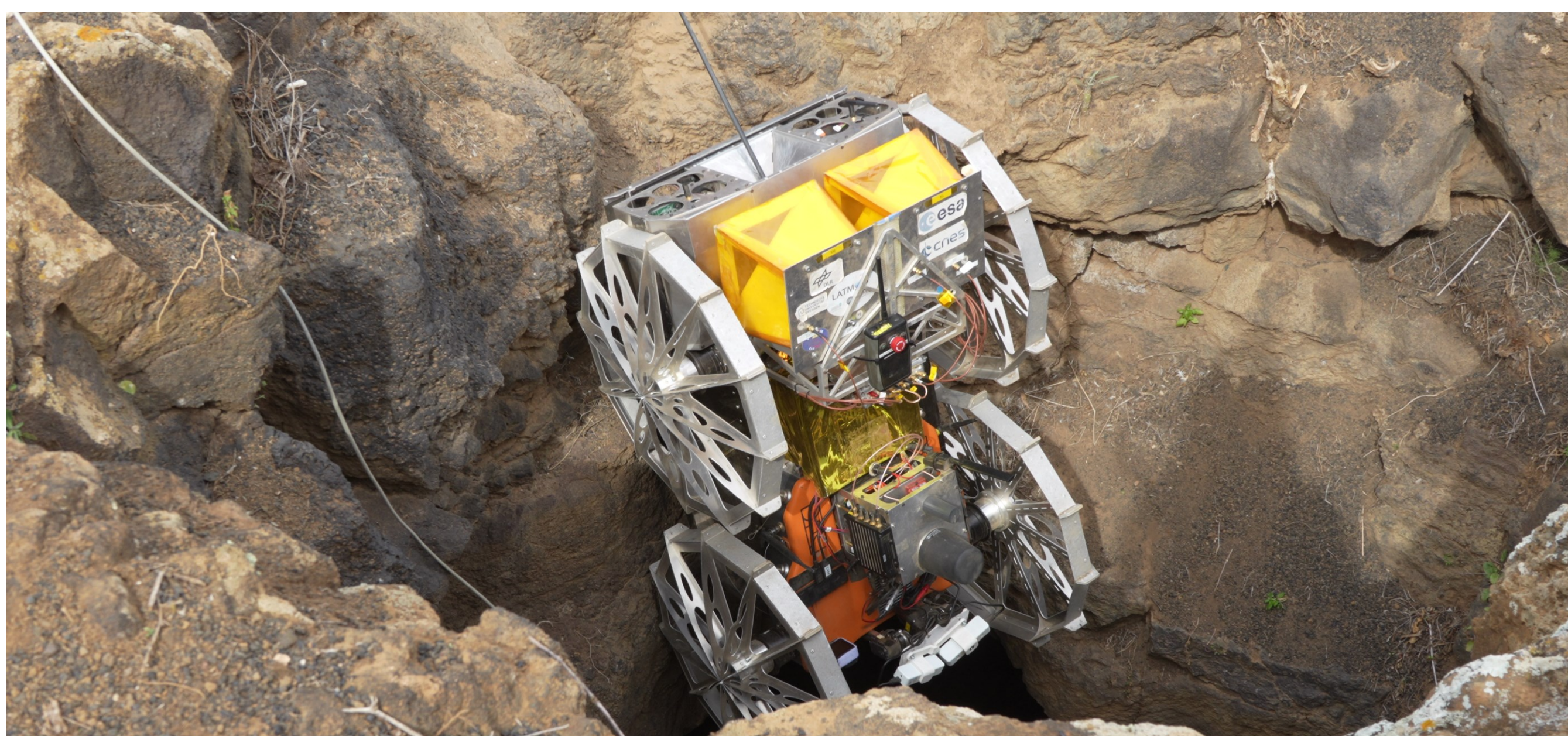
Abseilen in eine Lavaröhre mit robusten metallenen Rädern, einem Abseilenmodul, einem Bodenradar und einer Computer-Nutzlast (Foto: Meltem Fischer)
