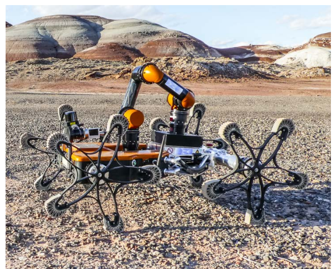
Coyote III ausgerüstet mit dem Manipulatoremodul SIMA
