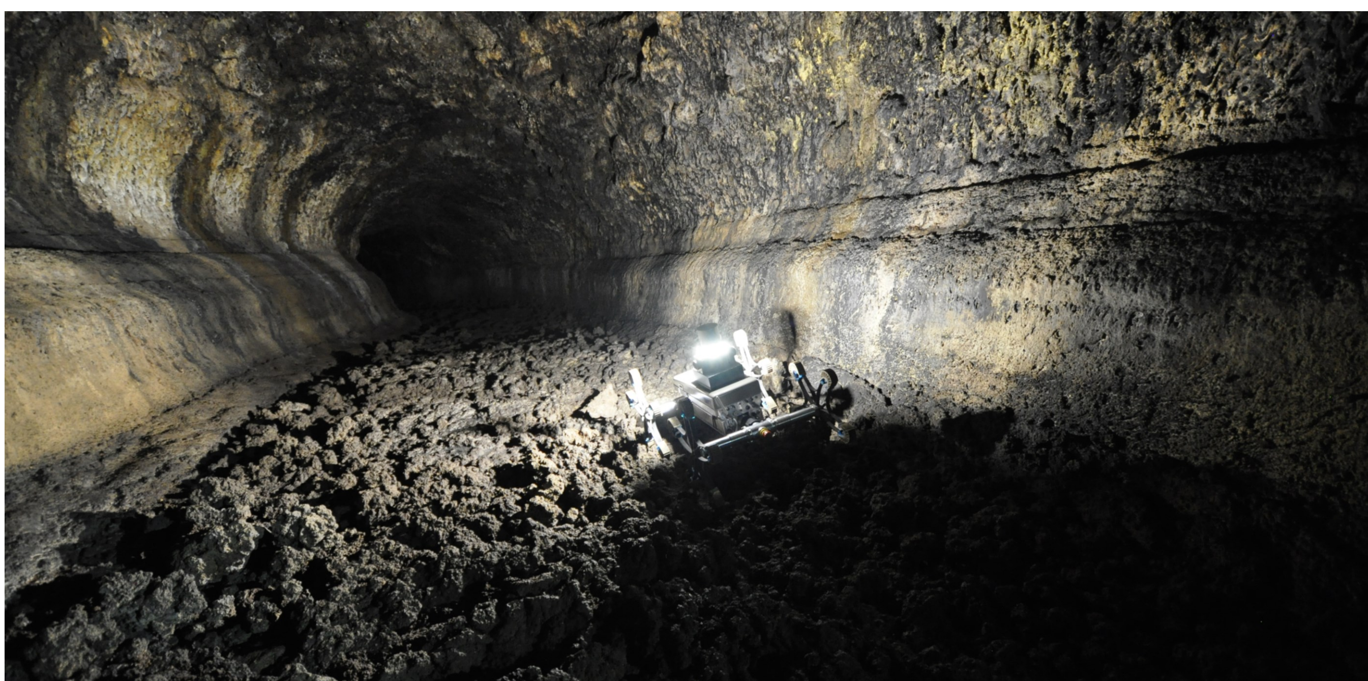
Asguard v4 navigiert durch steile Hänge und raue Oberflächen in einer Lavaröhre. (Foto: Raúl Domínguez, DFKI GmbH)
