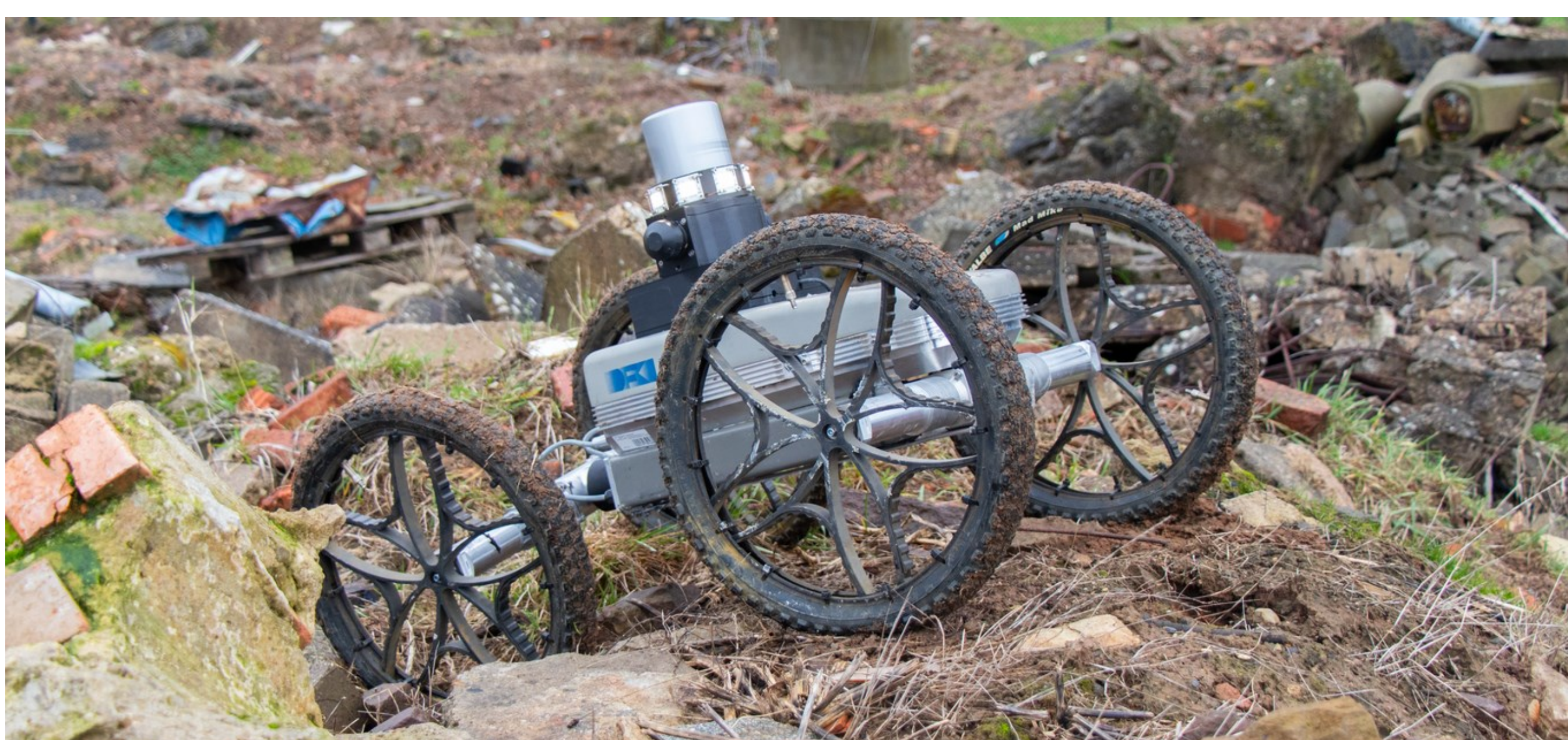
Tests mit Standardrädern bei der Bundesanstalt Technisches Hilfswerk (Foto: Florian Cordes, DFKI GmbH)
