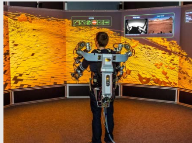
Steuerung von Coyote III über das Exoskelett im Bremer Virtual Reality Lab
